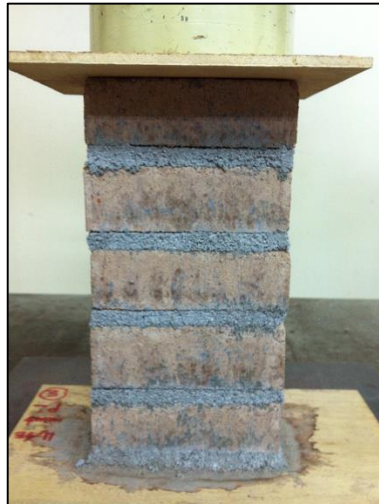
Rajah 1 Gambarajah menunjukkan ujian kekuatan mampatan dinding bata UCCB.
